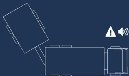
Alle 50mm-Kupplungen können mit einer Schwenkwinkelwarnanzeige ausgestattet werden. Mit diesem Warnsystem wird der Fahrer alarmiert und kann eine Kollision zwischen Fahrzeug und Anhänger vermeiden, bevor es zu spät ist. Diese Sicherheitsfunktion spart Zeit und Ärger beim Rückwärtsfahren und Sie vermeiden Schäden und kostspielige Reparaturen.
