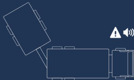
Todos los acoplamientos de 50 mm pueden equiparse con un sistema de aviso de jackknife. Grâce à ce système d'avertissement, le conducteur est alerté en amont et peut éviter la mise en portefeuille avant qu'il ne soit trop tard. Cette fonction de sécurité permet de gagner du temps et d'éviter les complications lors de la marche arrière. Elle vous évite également d'endommager l'équipement et d'avoir à effectuer des réparations coûteuses.
